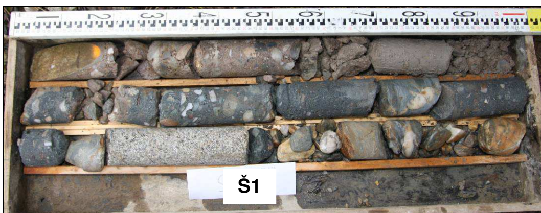
Obr. č. 2 - diagnostický vrt Š1 - opěra Šumperk
