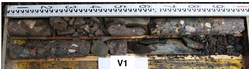
Obr. č. 1 - diagnostický vrt V1 - opěra Šumperk
